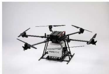
PD6B-Type3 第一種型式認証申請中（最大離陸重量が25kgを超える無人航空機）
