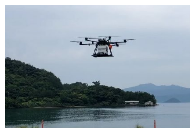
PD6B-Type3 第一種型式認証申請中（最大離陸重量が25kgを超える無人航空機）
