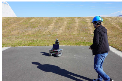
LiDER※3を活用した三次元地図生成実験 （RTF瓦礫・土砂崩落フィールド）
