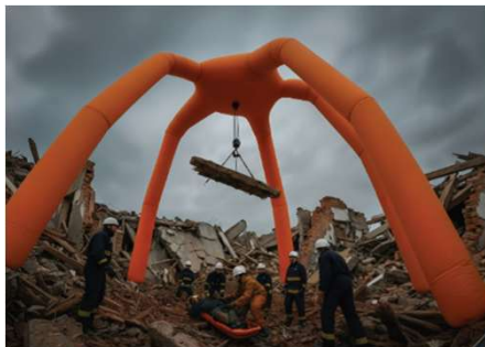
パワーインフレーター(目標像) 軽量で可搬性に優れたロボット。作業現場で空気を入れて展開し、1トン程度の重量物の取り扱いを目指しています。
