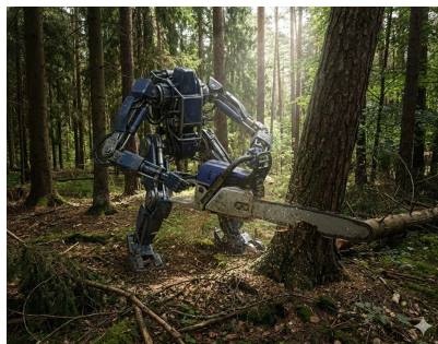
パワーアバタ(目標像) 油圧駆動で力作業を行うロボット。エグゾスケルトン、遠隔操作、自律動作、と展開していく計画です。
